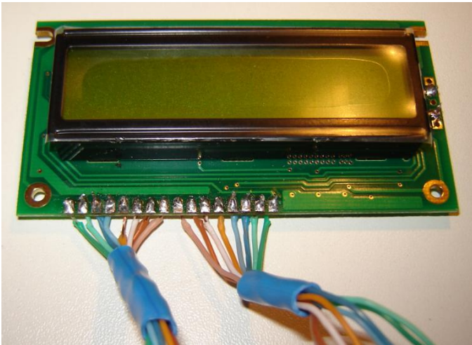
Figura 1 – Solde os cabinhos na placa do LCD.
