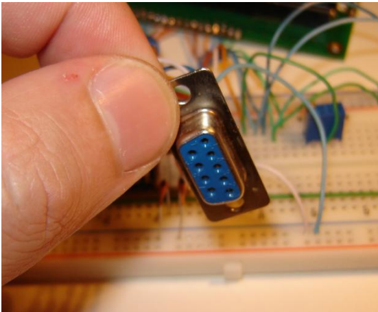
Figura 11 – Conector do circuito de gravação do MC.
